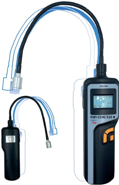
Детектор газа, предназначенный для обнаружения утечек газа из газопроводов, запорной арматуры и другого газового оборудования в воздухе рабочей зоны.
